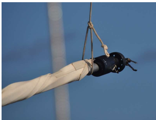
tako zgleda od blizu polomljen/odlomljen konec genoa
