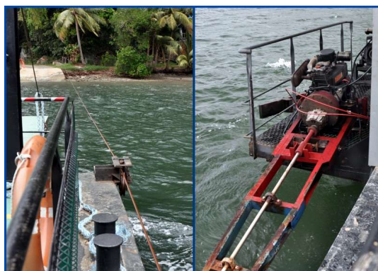
tak motorček poganja vso zadevo in se po zajli vlečemo na drugi konec
