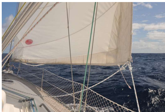
UV zaščita, ki je bila zašita naknadno je bila žal z napačno kakovostjo niti in se je sedaj začela parati
