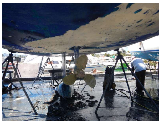
se pa vidi, da propspeed ni brez veze....niti ene alge, trave ni na propelerju
