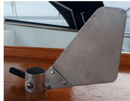
levo: hitro popravilo smerokaza z ribjim repom; desno: končna rešitev
