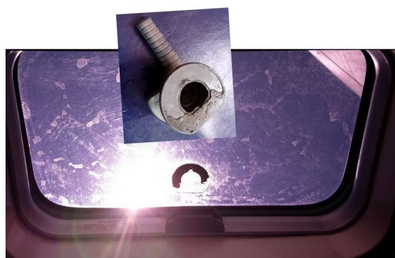
tako grdo se je odlepil ročaj in ker je to prednja kabina, mora okno biti dobro zaprto
