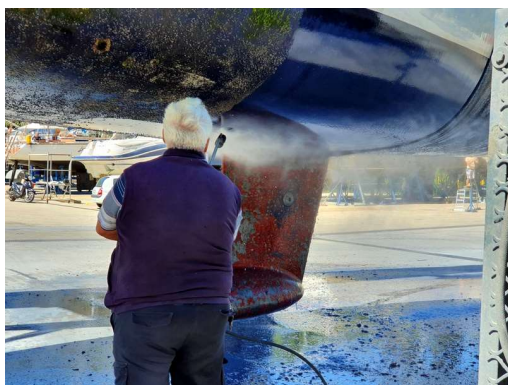
dobro se vidi očiščen trup in kakšen je obraščen del
