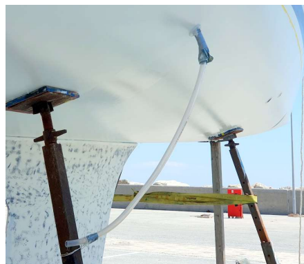
ideja za drugič kako naštimiti cev, da ti ne teče voda iz odtoka po sveže namazanem antifoulingu
