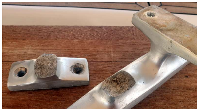
pri demontaži bitve (brez kladiva ipd) se je počeni del kar odlomil
