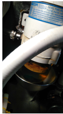
V Racor filtru za nafto, ki je hkrati separator za vodo ni nič vode. Tako mora biti.
