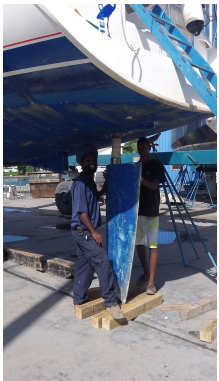
Popravilo ležaja na krmilu. Imel je preveč tolerance, ker se je izrabil.
