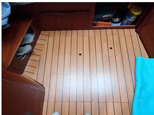
Pod sva pred leti dvignila za 12 cm in s tem naredila veliko prostora za orodje pod celo prednjo kabino.
