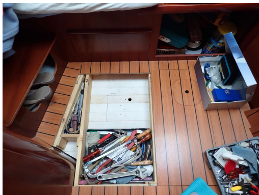
Pod orodjem pa slepi pod. Takrat provizorično narejen iz smreke. Super se drži in po 10 letih je les kot nov.
