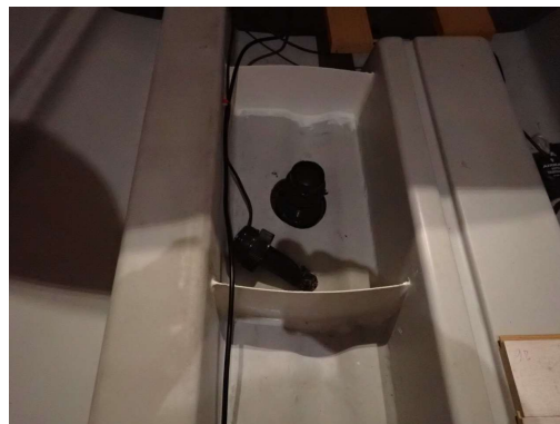
Takole sem naredil pregrade, da se voda ne razliva po celi barki ampak ostane v bazenčku.
