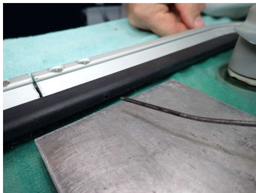
Nova guma je v okvirju in z razžarjeno žico sem naredil luknjico za odzračitev. Se jo pa na sliki slabo vidi.
