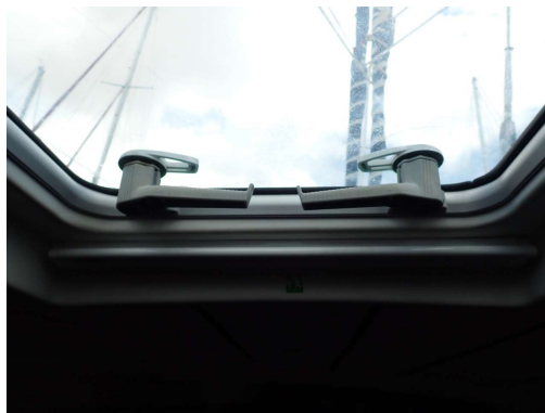
To je zdaj čisto druga pesem. Guma nalega na okvir po celi površini in vse je paralelno.
