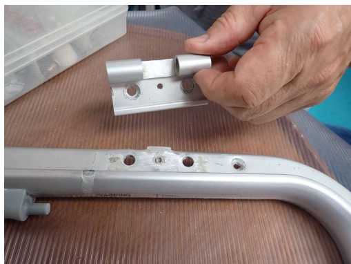
Pant in ležišče panta sta bila nekoliko zvita. Zdaj je bolj ravno.
