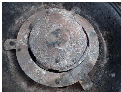
precej je razpadla in skozi luknje uhajajo plameni in žar ne peče lepo ampak zažge hrano nad plamenom.
