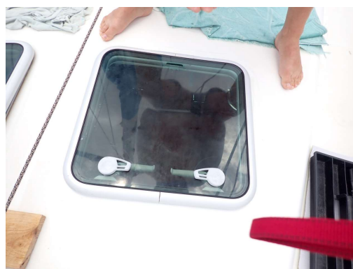
Postavljeno na mesto, privijačeno in očiščeno.
