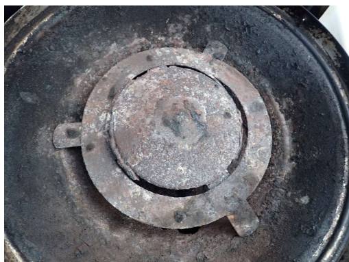
Tako ubogo pa izgleda žarilna kupola nad plamenom.
