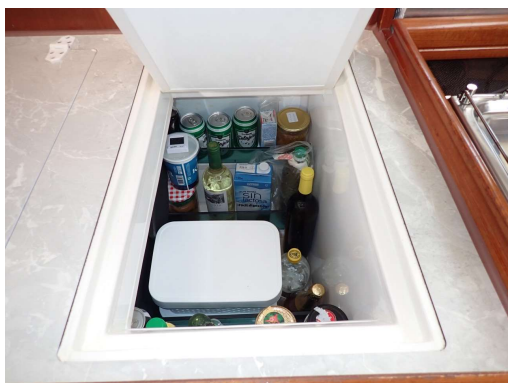
Desni hladilnik se hladi le skozi vmesno steno. Zdaj, ko je levo od njega vključena skrinja sem moral dati vmes še malo izolacije, da notri ne zmrzuje.
