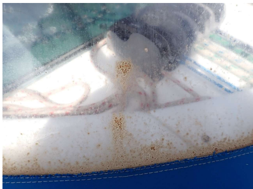
Prej: Plastika na sprayhoodu je bila že v zelo slabem stanju
