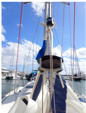
Navijalec pa se po tem, ko ga razstaviš, lahko dvigne po profilu navzgor.
