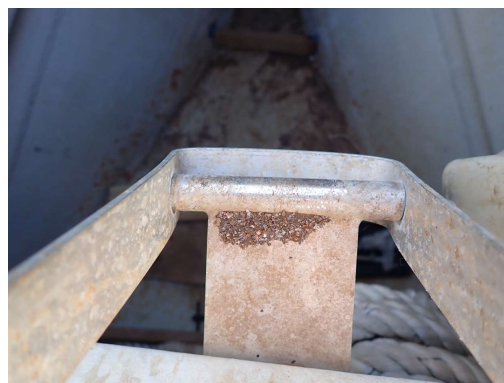
V sidrniku in povsod naokrog je bilo polno delcev rje.
