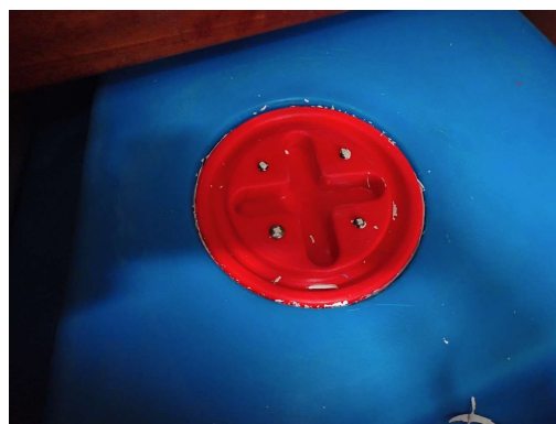
Zlomljena in pred leti popravljena inšpekcijska luknja dodatnega diesel rezervoarja.
