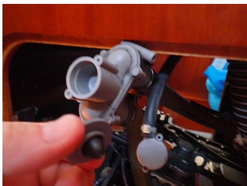
Antisifon z oddušnikom, ko sem ga že potegnil iz motornega prostora in odprl.
