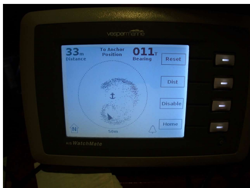
AIS-ov sidrni alarm. črne pikice so bivše pozicije Herona. Radij kroga sem povečal na 50 m.
