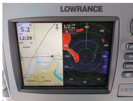
Še ista situacija na ploterju in radarju. Ploter je North-up, radar je head-up. Rdeča pika na radarju je čoln.
