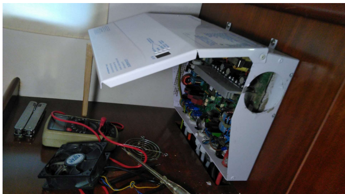
Kontroler hladilnika z pokvarjenim ventilatorčkom.
