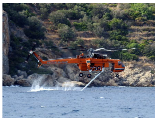
Erickson zračni žerjav z gasilsko opremo
