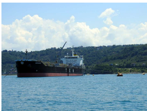
tanker za plin privezan v četverovez: 3x boja +sidro; priključen na plinovod, ki gre v plinohrame na obalo
