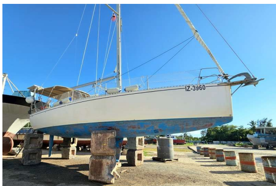
antifouling International po pranju podvozja - ga skoraj ni več
